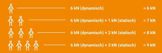
Diese Einwirkung wirkt am jeweiligen Anschlagpunkt. Bei Einzelanschlagpunkten (EAP) erfolgt dabei die Kraftableitung über den Anschlagpunkt und das jeweilige INNOTECH®-Produkt direkt in den Untergrund bzw. in die Untergrundkonstruktion.
